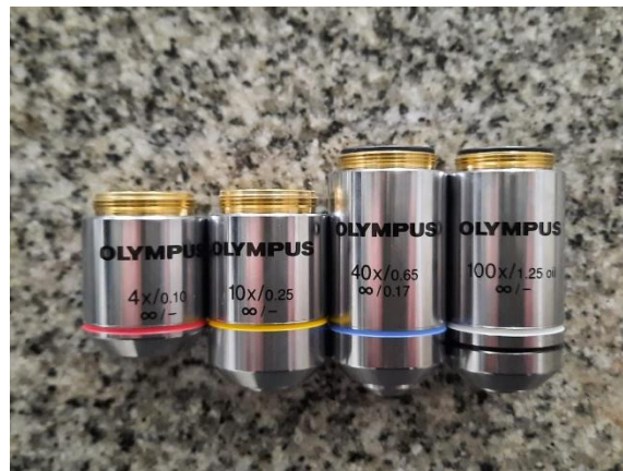
Figura 4. Imagen de los objetivos a seco y a inmersión de un microscopio óptico
